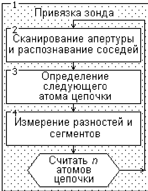
Рис. 6 Упрощённая блок-схема алгоритма. Процедура привязки зонда работает в фоновом режиме. Сканирование считается законченным, если длина цепочки достигла заданного значения n .
